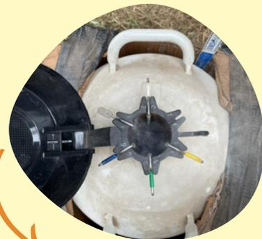
TANQUE CON NITRÓGENO LÍQUIDO EN EL CUAL SE ALMACENAN LAS PAJUELAS DE SEMEN
